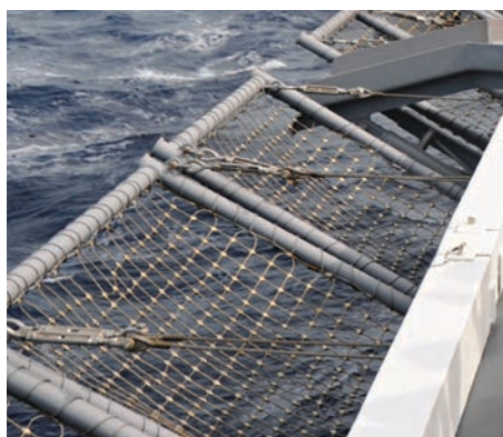
CABLE DE ACERO / CUBIERTAS DE VUELO
