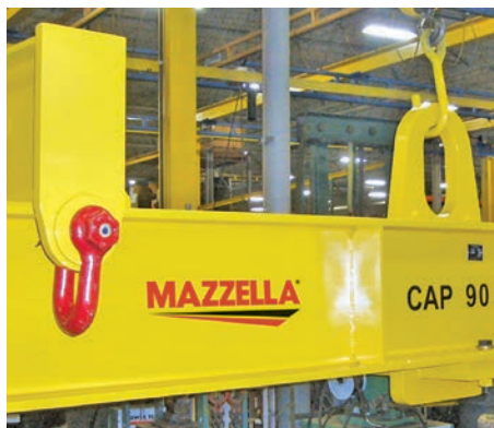
VIGAS DE ELEVACION
